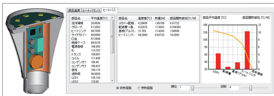
図4 LED素子からの放熱経路（ヒートバスタブ）
