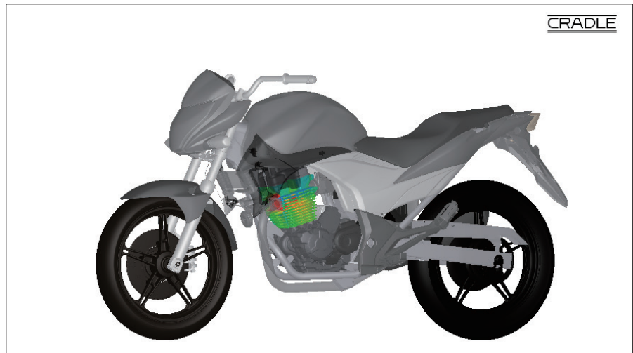
図3 CB300R 空冷エンジン温度
