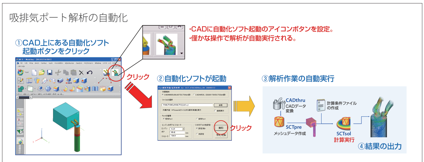
図1 自動化ツールの運用イメージ（吸排気ポートの場合） CADツール内の起動ボタンと自動化ツールの実行ボタンをそれぞれ1回クリックするだけで解析を実行できる。
