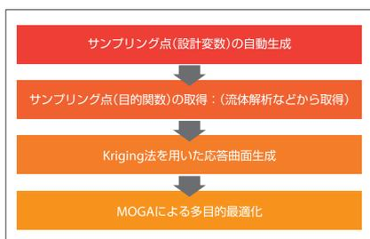
図3 EOptiを用いた最適化の流れ
