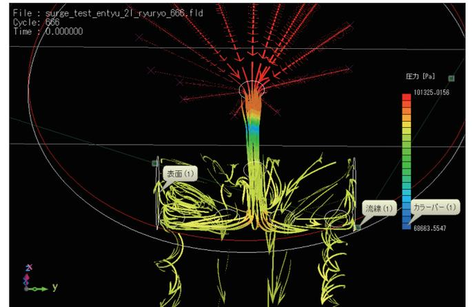
図2 吸気系の解析結果。リストリクタからサージタンク、インテークマニホールドにおける流れの様子
