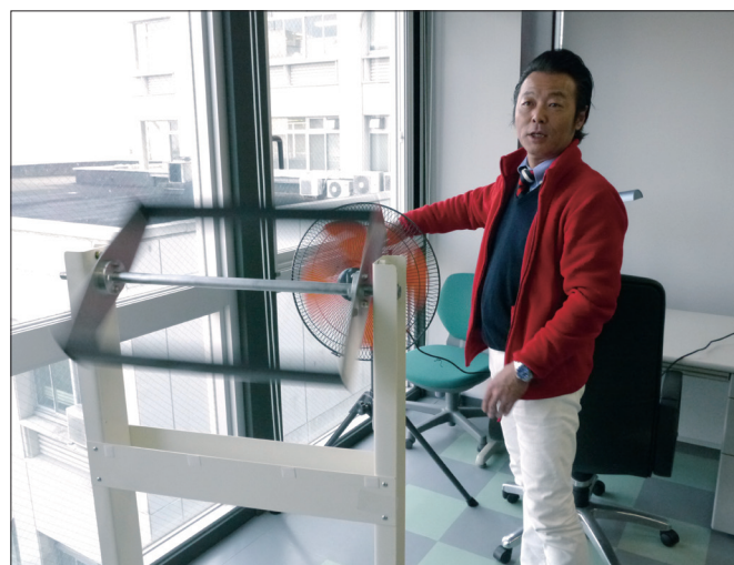
写真2 減風装置のデモ 風車が回り始めると強風がそよ風程度に弱まる
