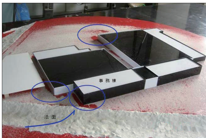
図3 敷地内の冬期における強風領域推定を目的とした風洞実験 実験の結果、南側のメインエントランス周辺に冬期強風領域が発生するのがわかった。強風領域形成の原因としては、南側法面により増速された風が事務所西隅角部に当たったことによるものと考えられる（青丸が強風領域）
