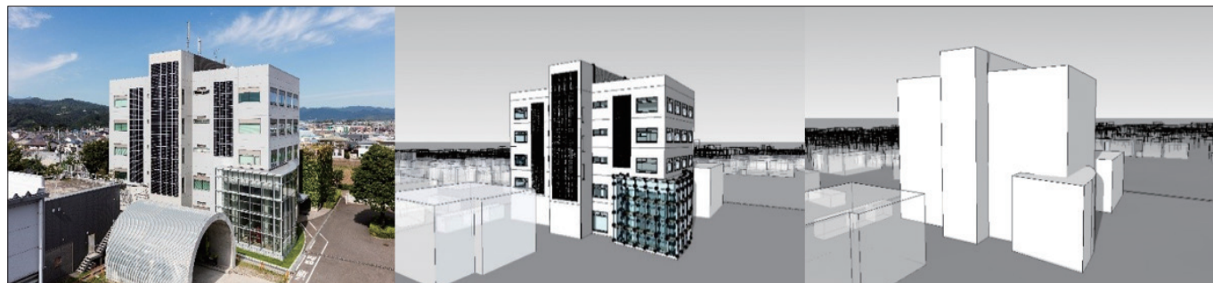
図2 東急建設(株)技術研究所写真とBIMモデル(詳細モデルと簡易モデル)
