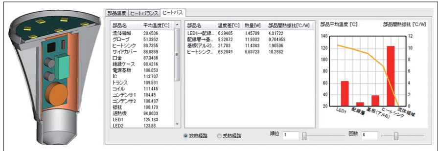
図4 LED素子からの放熱経路（ヒートパスタブ）
